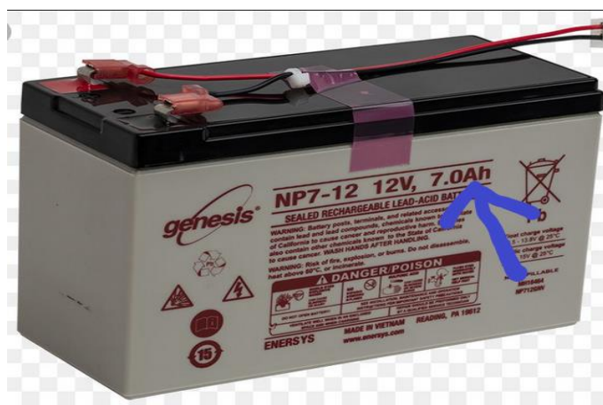
Figura c144: Uma bateria recarregável de 7 Amperes-hora (Ah)
