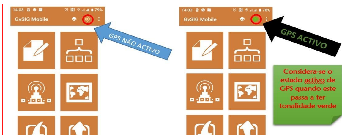
Figura 2. Etapas de verificação do sinal de GPS
